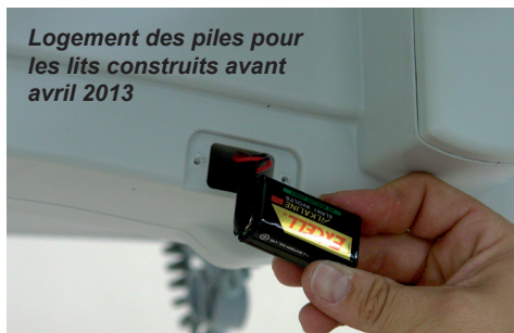
Logement des piles pour les lits à partir d'avril 2013 ou pour les lits construits avant avril 2013 ayant subi des transformations
