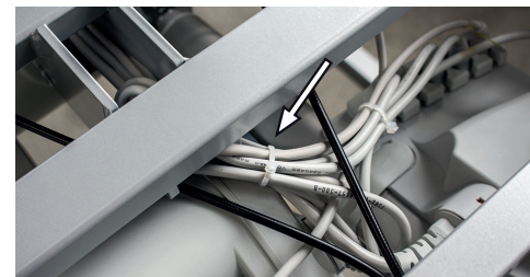
Position du serre-câbles au-dessus du moteur du plan de couchage côté pied .
